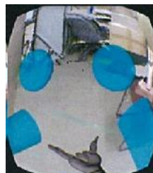
(図4) HMDで見たVR空間 左右の青い表示がアバターの腕 下部のグレーはロボットのアーム
